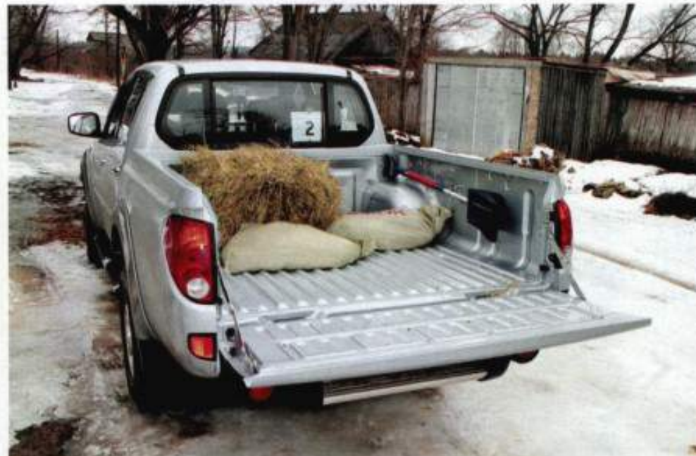
Сзади модернизированные машины с увеличенным кузовом легко узнать по планке-подштамповке над задними фонарями — борта стали на 55 мм выше
