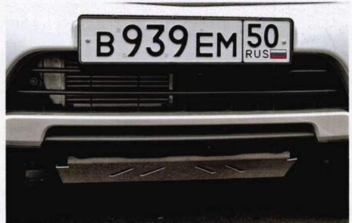
Если раньше интеркулер был хоть как-то защищен крупноячеистой решеткой в бампере, то после рестайлинга установка дополнительной сетки стала нужна как никогда
