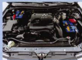
Двигатель мощностью 178 л.с. оснащен турбокомпрессором с изменяемой геометрией, давление наддува увеличено с 1 до 1,3 бара, выше производительность системы впрыска
