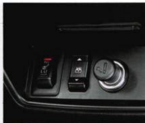
Одна из клавиш на центральной консоли управляет электроприводом заднего стекла кабины
